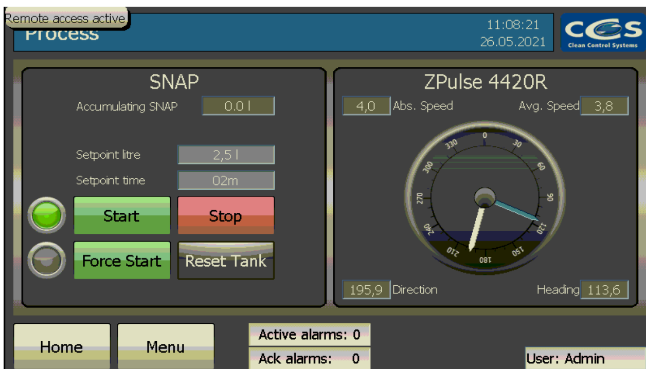
Figur 11 Illustrasjon av det grafiske brukergrensesnittet (GUI) som ble utviklet til det nye doserings- og distribusjonssystemet. Retning av strømningsforhold er angitt i klokken til høyre i billedkanten, sammen med faktisk strømningshastighet.
