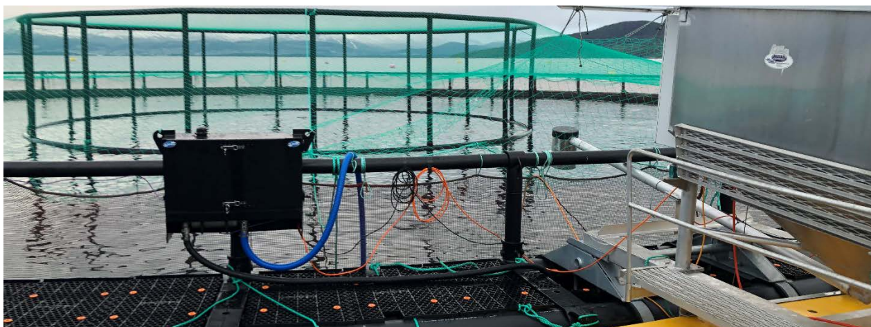
Figur 9 Plassering av pilot på merdkanten. Kompakt og lett tilgjengelig, uten store utfordringer knyttet til sikker ferdsel. Fôringsautomat skimtes til høyre i bildet. Foto: Robert Wolff – SINTEF.
